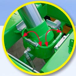
Cilindro telescópico de vuelco de doble oscilación situado en posición avanzada en el bastidor
