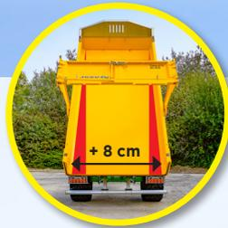
Fluidez de vaciado gracias a una caja cónica en HARDOX 450
